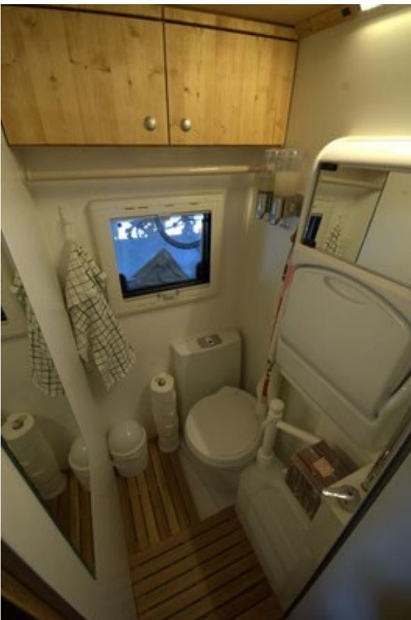
Nasszelle mit Spiegelschrank und Klappwaschbecken, Schwenktoilette und Frischwasser-Pumpstation
