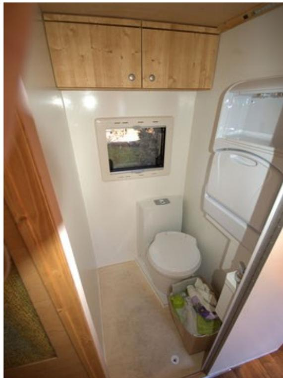
Nasszelle mit Schwenktoilette und Klappwaschbecken und wasserdicht versiegeltem Boden
